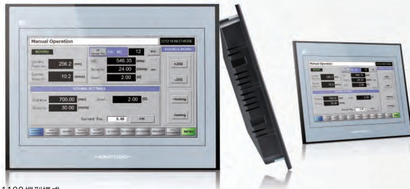
TS1100 機型構成 TS1100□ ——【功能規格】無：內建置LAN埠 i：內建LAN埠
